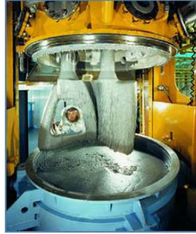
Figura 7.1 Homogeneizador planetario (MTCR, 2010)
