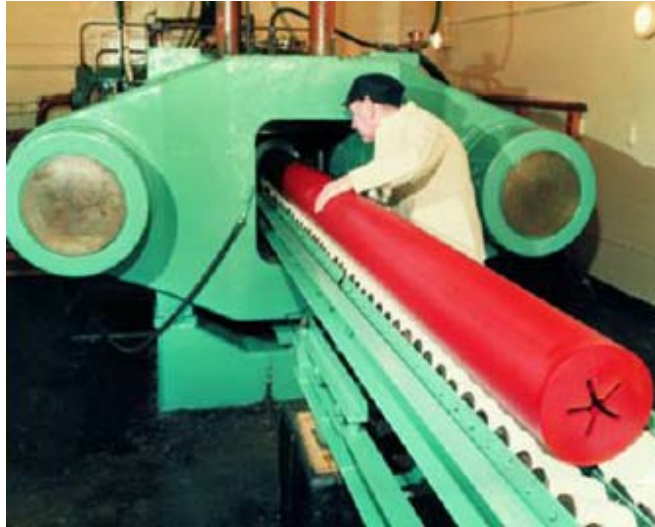
Figura 4.2. Grano propulsor de combustible sólido (Tomada del MTCR, 2010)
